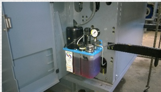
Graissage centralisé automatique suivant les instructions au pupitre PLC
